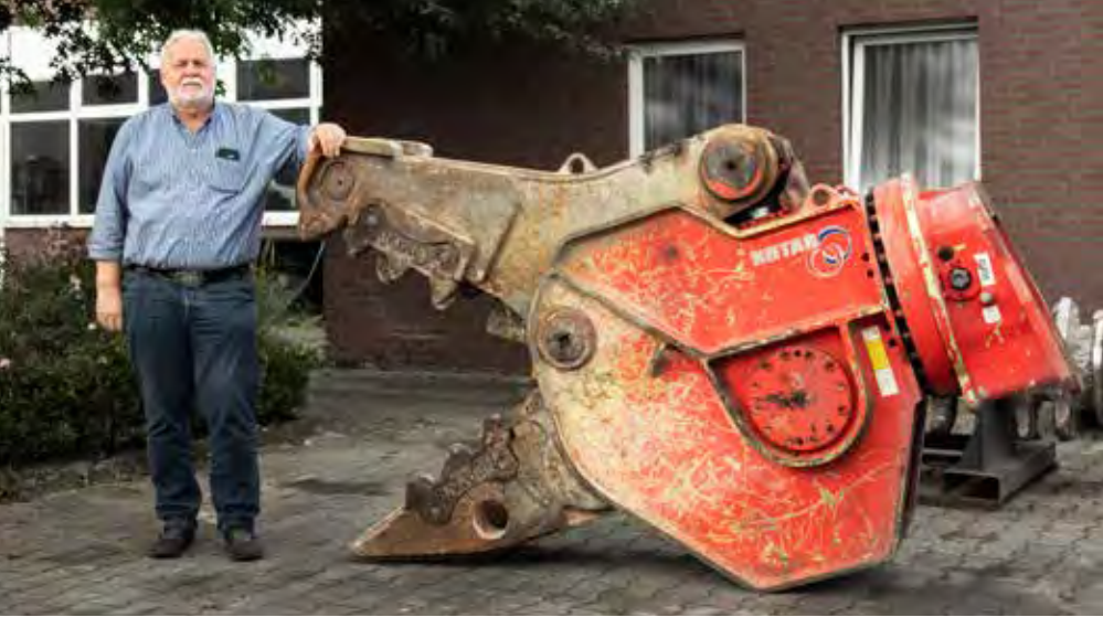
Firmengründer Wilfried Bentrup neben einem Pulverisierer der Marke Rotar. Das schwere Gerät wird an einem Kettenbagger angebaut und zerbröseln im Abbruch Beton und Steine. Der Pulverisierer wiegt 3,5 Tonnen und ist damit fast so schwer wie 3 VW Golf.
