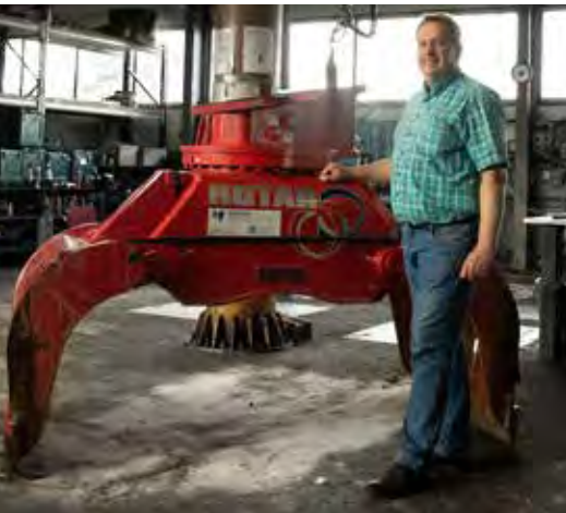
Geschäftsführer Frank Bentrup ist Maschinenbau-Ingenieur. Eine optimale Voraussetzung in seinem Geschäft, in dem sich alles um Hydraulik und Mechanik dreht. Hier steht er in der Werkstatt neben einem Abbruch-Sortiergreifer mit einem Eigengewicht von 1,6 Tonnen.
